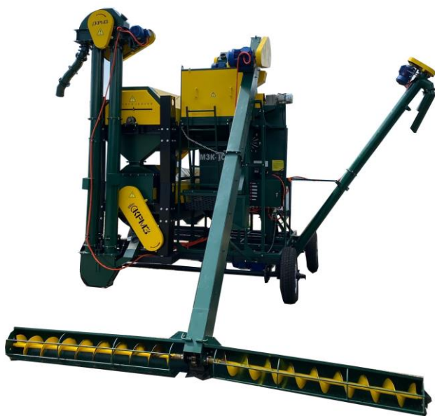
Рис. 7 – Машина МЗК-7СТ — с триерными цилиндрами и элеваторами вертикальной выгрузки
