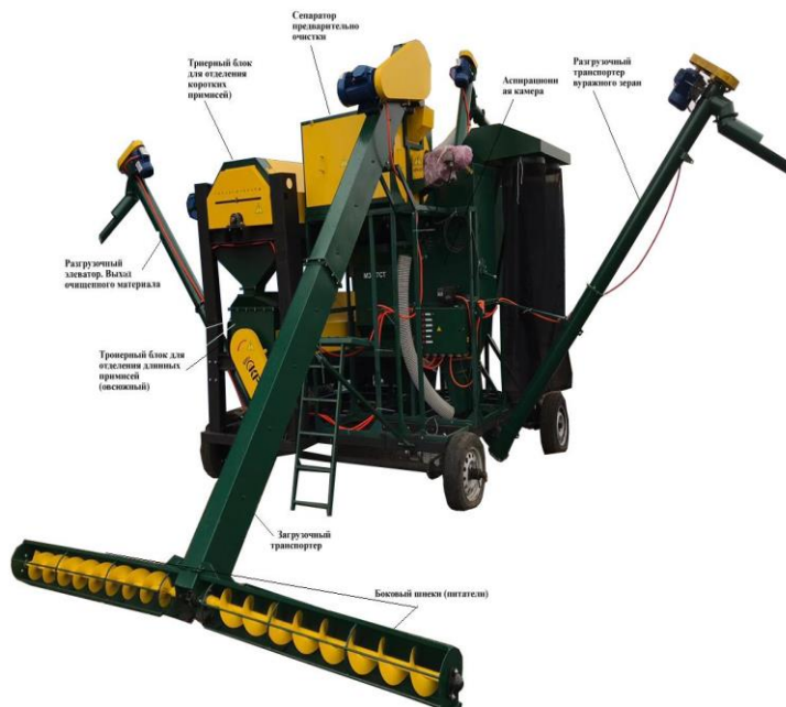
Рис. 6 – Машина МЗК-7СТ – с триерными цилиндрами и боковыми шнеками
